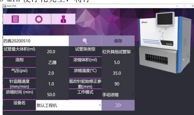
图 1 AutoEVA-20Plus 全自动平行浓缩仪氮吹浓缩条件
